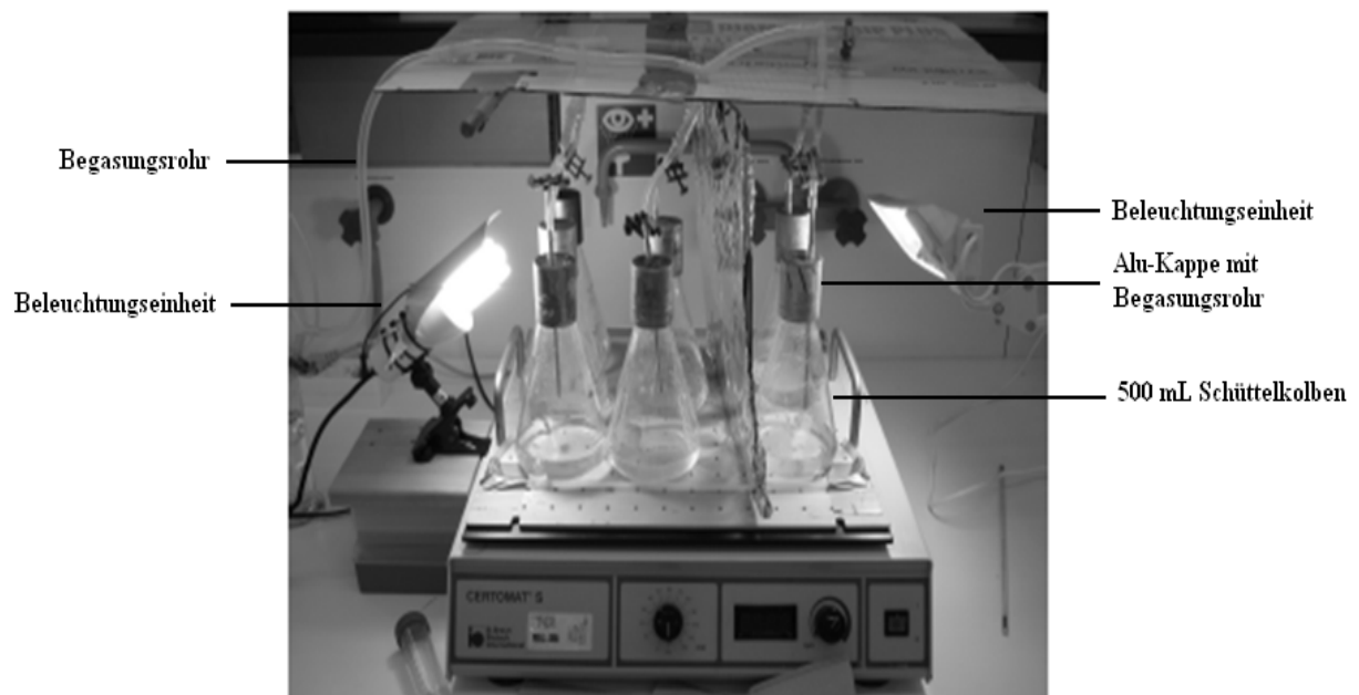
Abbildung 3.16: Das Kolbenkappen-Begasungssystem (mit oder ohne CO 2 ) während der Mikroalgenkultivierungen im Schüttelkolben.
