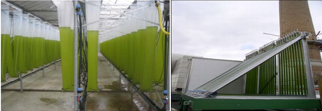
Abbildung 2.16: Photobioreaktoren in einer Versuchsanlage zur Sequestrierung von CO 2 aus Kraftwerk- Abgasen [61] und [62].
