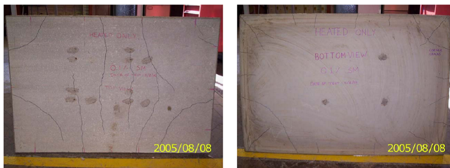
Abbildung 2.9: Probekörper mit Belastung durch Eigengewicht, links Ansicht von oben, rechts von unten (aus Abu [3])
