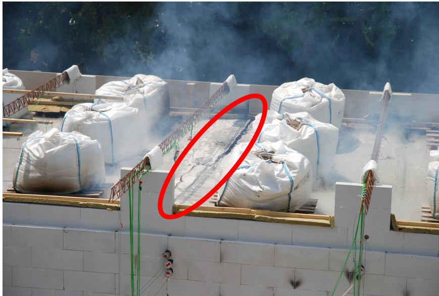
Abbildung 7.1: Versagen des Raumabschlusskriteriums trotz Einhaltung des Tragfähigkeitskriteriums und Isolationskriteriums beim Juli-Versuch in Dachau [81]
