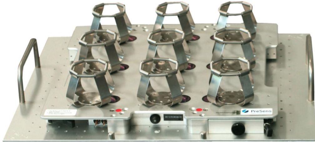
Abbildung 4.1: Ausgangsmodell des Multisensorsystems. Auf Grundlage des kommerziell erhältlichen Shake Flask Reader von PreSens GmbH [62] erfolgte die Entwicklung des Dreisensorsystems.
