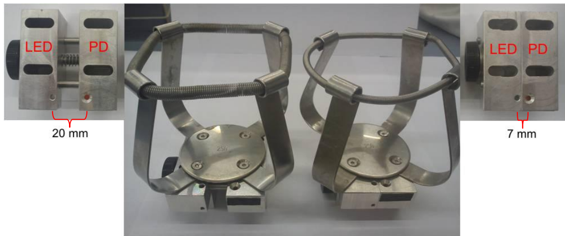
Abbildung 4.12: Darstellung des modifizierten Optikblocks zur Abstandsvariation zwischen den optoelektronischen Komponenten.
