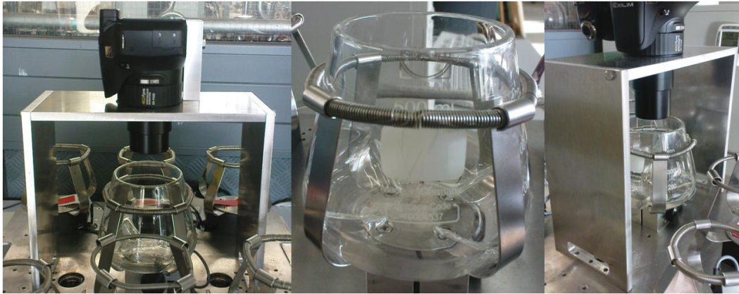
Abbildung 4.5: Messaufbau zur Beobachtung der Flüssigkeitsbewegung im Kolben durch Highspeed-Videoaufnahmen unterschiedlicher Formazinlösungen.
