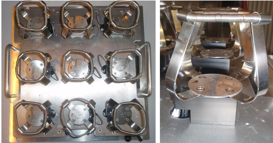
Abbildung 4.2: Foto des provisorischen Prototyps zur Streulichtsensorik. Die optischen Sensoren für pO_2 und pH wurden für den Testsensor entfernt. Diese Machbarkeitsstudie erfolgte im Rahmen einer Diplomarbeit [38].
