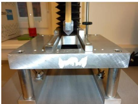
Abb. 208: Druckwerkzeug TA.XTplus
