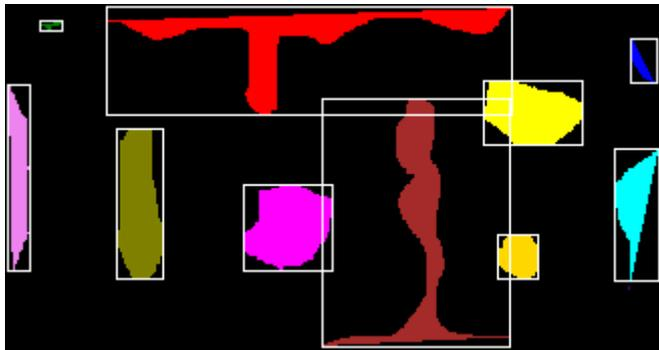
Abb. 43: Segmentierte Poren mit umgebenden Rechtecken
