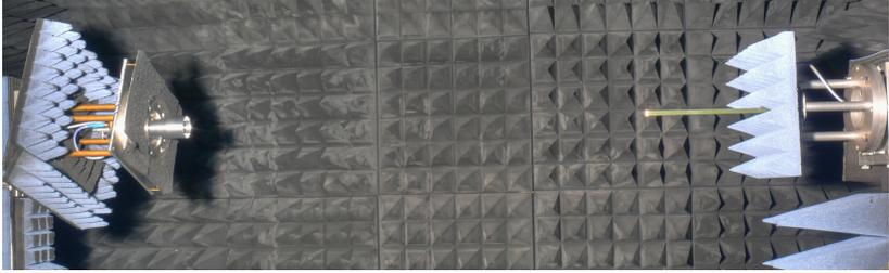
Abbildung 3.25. Messanordnung zur Bestimmung der Fernfelder der Multimodeantenne
