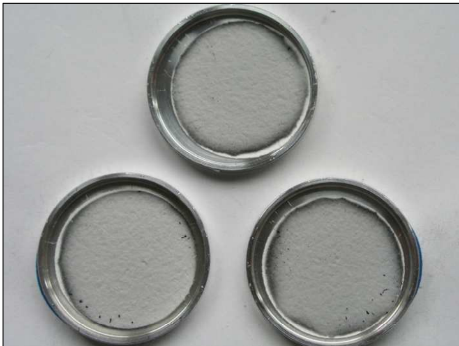
Abbildung 4-20: Verteilung von Kupferoxid auf Filterpapieren mit 100 ml/min Kammerstrom.
