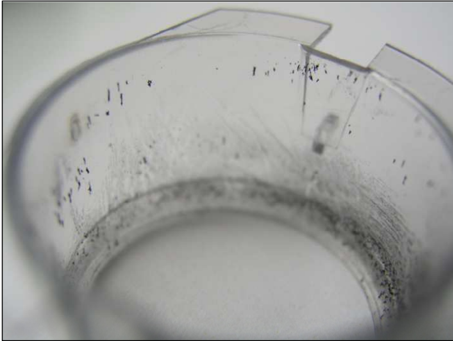
Abbildung 4-21: Ablagerungen von Partikeln am Kunststoff des Inserts mit 100 ml/min Kammerstrom.
