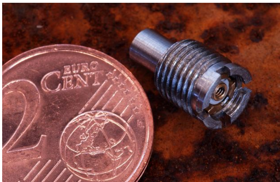
Abbildung 4.6: Piezoelektrischer Kraftsensor, Eigenentwicklung
