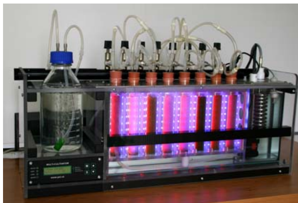
Abbildung 2.3: Multicultivator MC 1000 OD der Firma Photon Systems Instruments (verändert nach PhotonSystemsInstruments, 2011)
