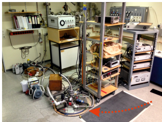
Abbildung B.1.: Foto des verwendeten ^3\text{He} - Systems. Der eigentliche Kryostat ist für ein einfacheres Handling in den Boden eingelassen (roter Pfeil).
