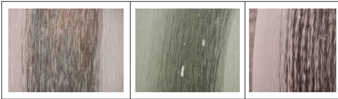
Abbildung 43: Oberfläche TiAlN + WC/C von WDK-4 (verschiedene Vergrößerungen)
