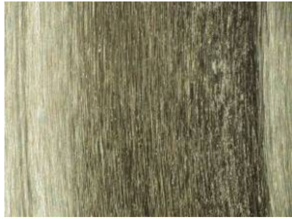
Laufspur der Losscheibe Abtrieb, Breite ca. 6mm
