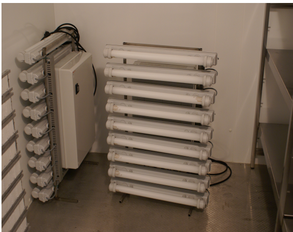
Abb. 20 Rags, mit Leuchtstoffröhren Typ 1B (UV-A-351) bestückt
