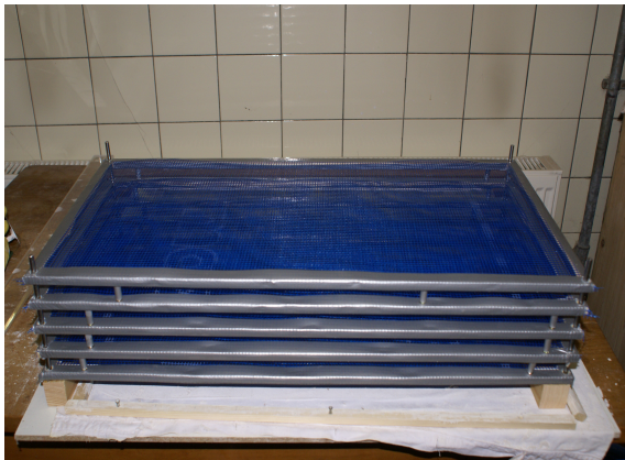
Abb. 18 Horden für die Begasung der Putzplatten
