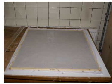
Abb. 14 Fertig geputzte Platte
