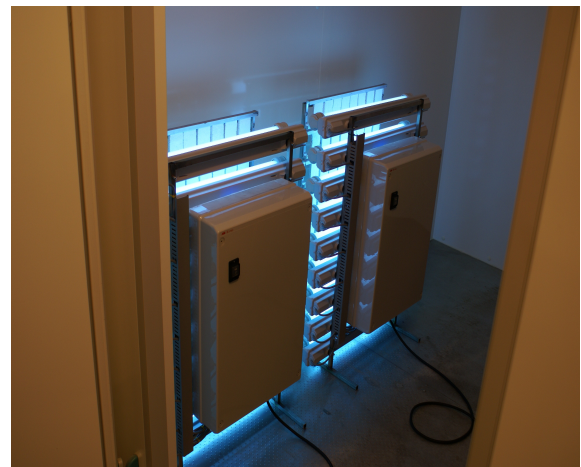
Abb. 21 Bestrahlung der Probekörper mit UV-Licht
