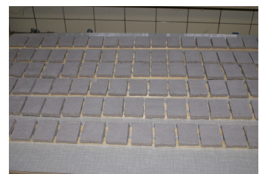
Abb. 17 Putzplatten beim Trocknen
