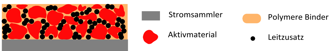
Abbildung 7: Aufbau einer typischen Multikomponentenelektrode
