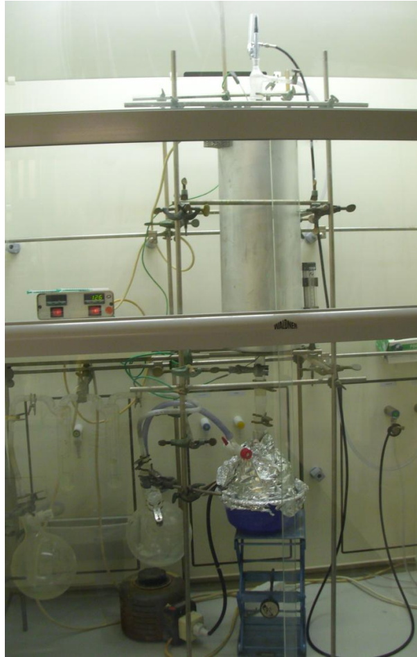
Abbildung 39: Fotografische Abbildung der Düsenprühyrolysenapparatur
