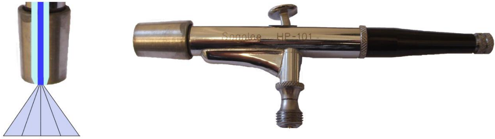
Abbildung 35: Fotografische Ablichtung der verwendeten Zweistoffdüse
