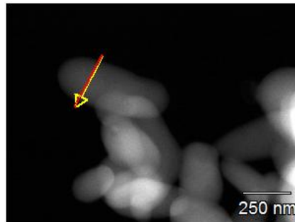
Abbildung 73: TEM-Aufnahme des Linescan eines \text{LiFePO}_4/\text{C} -Partikels mit 1 wt% C
