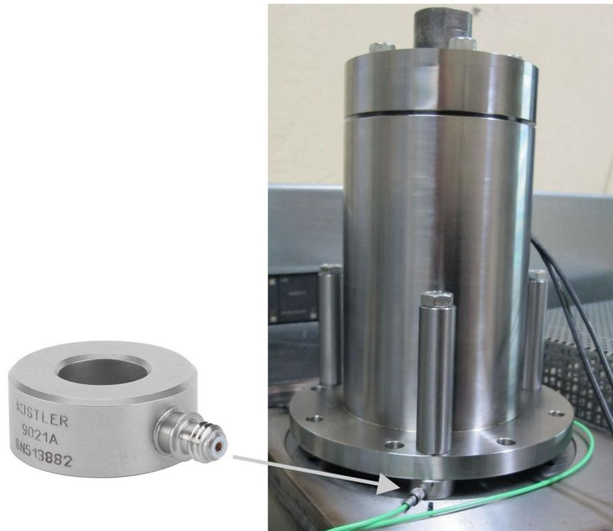
Abbildung 6.5: Messunterlegscheibe im Einbau
