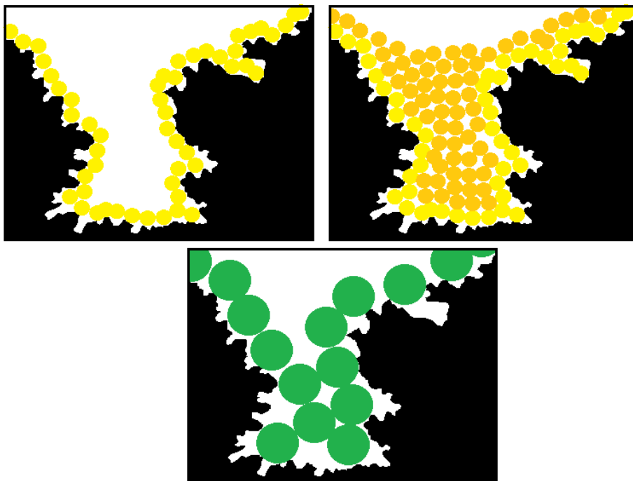
Abbildung 2.6: Schematische Darstellung unterschiedlicher Adsorbensen (gelb und grün) auf einer Rußoberfläche in Mono- und Multilagen (orange).
