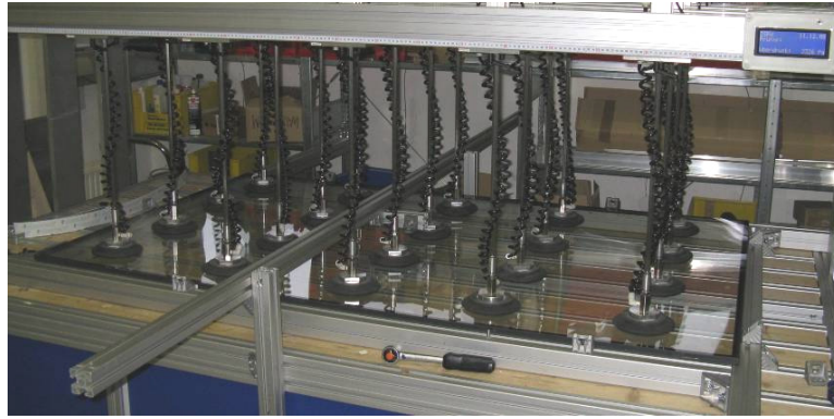
Abbildung 8.15: Isolierverglasung im Prüfstand, ohne Einspannung.
