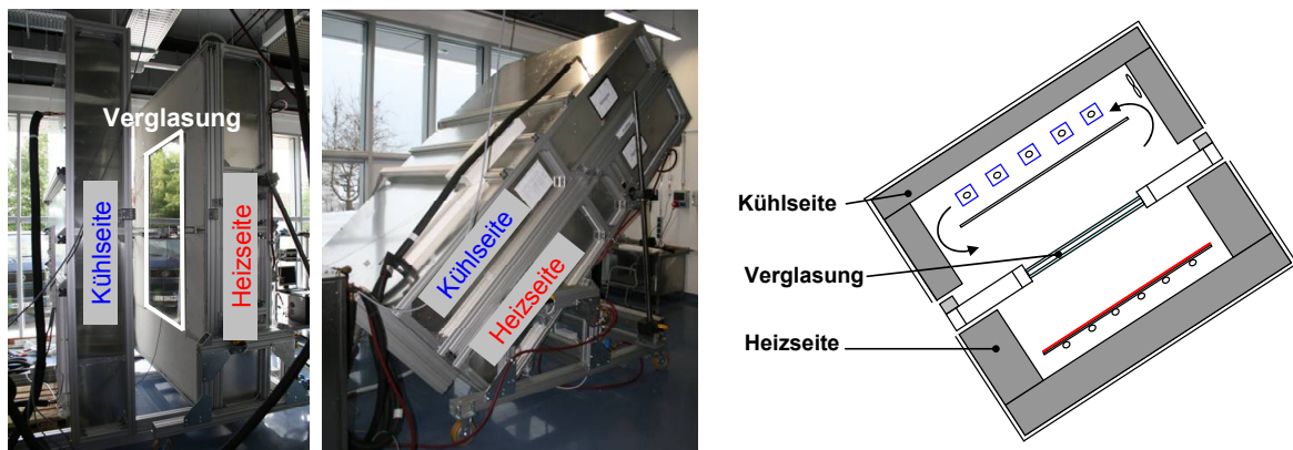
Abbildung 8.23: Aufbau des Hochtemperaturbelastungsprüfstands.
