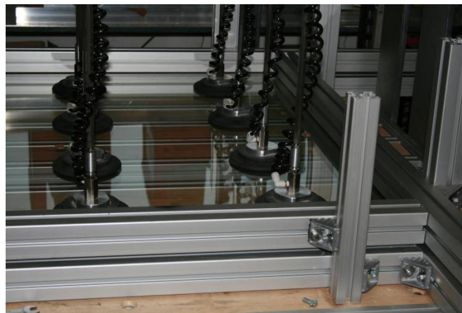
Abbildung 8.17: Isolierverglasung im Prüfstand, mit Einspannung.
