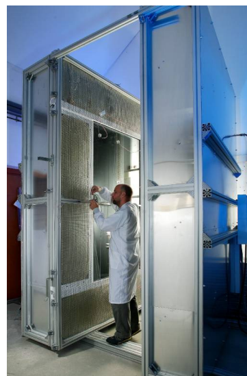
Abbildung 8.8: Temperaturbedingte Scheibenwölbung, links: Messergebnisse im Vergleich zu berechneten Werten, rechts: Messaufbau.
