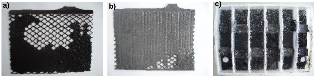
Abbildung 4-31. Einzelne Batteriekomponenten nach beendetem Zyklentest mit 17,5 % Entladetiefe (Variante A): a) Positive Batterieelektrode mit schmieriger Aktivmasseoberfläche und ausgerichteten Masseteilchen, b) Negative Batterieelektrode mit aufgequollener Aktivmasse, c) grauschwarze Färbung des Batterieelektrolyten (Ansicht: Batterie von oben)
