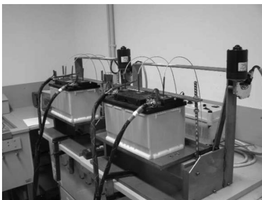
Abbildung 3-3. Bewegungsprüfstand Wippe, links und Hexadriver®-Prüfstand der Firma Simtec, rechts (mit freundlicher Genehmigung der Firma Simtec Systems)
