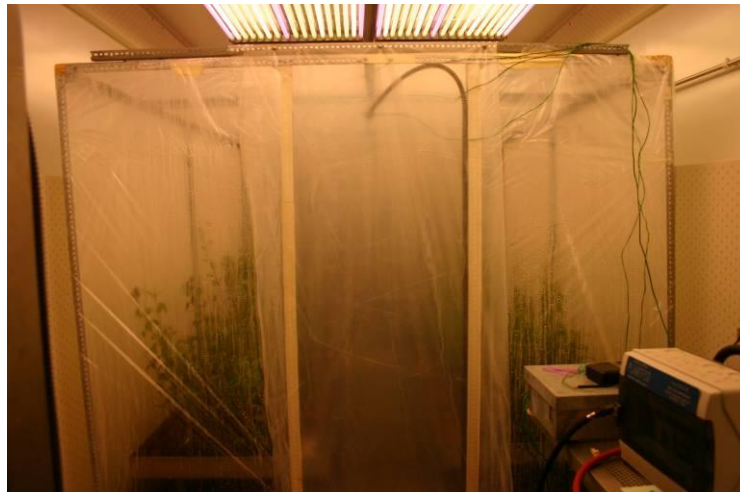
Abbildung 8: Folienkammer mit Hochdrucknebelssystem innerhalb einer Klimakammer
