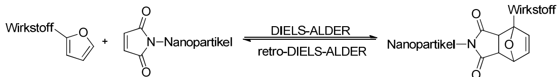
Schema 3: DIELS-ALDER und retro-DIELS ALDER -Reaktion zwischen Furan und Maleimid zur Konjugation von Nanopartikel und Wirkstoff im Rahmen eines drug release Systems.
