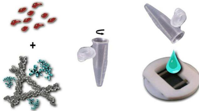
**Abb. 34:** Schematische Darstellung zur Präparation zellbeladener, *in situ* geformter Hydrogele.<sup>139</sup> Rote Körper deuten Zellen an, während graue/ blaue Stränge die beiden Polymerkomponenten visualisieren. Als Negativform für das myocardiale *tissue engineering* wurde eine Teflon-Gießwanne eingesetzt.<sup>140</sup>
