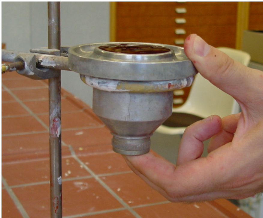
Abb. 34: Viskositätsmessung mit dem DIN-Becher
