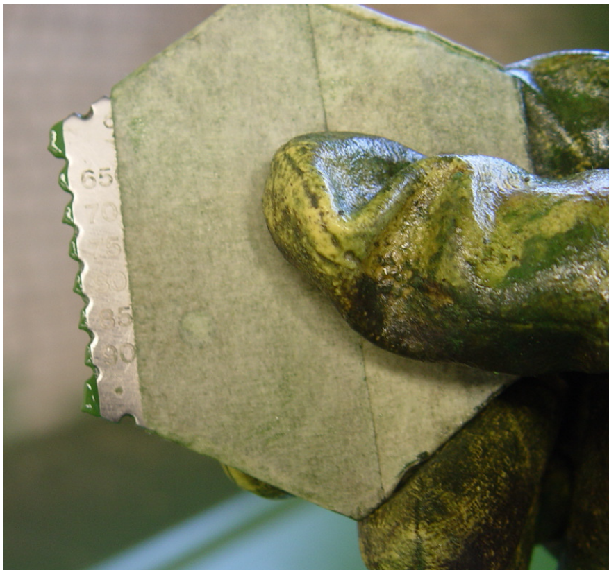
Abb. 36: Messung der Nassschichtdicke mit einem Messkamm
