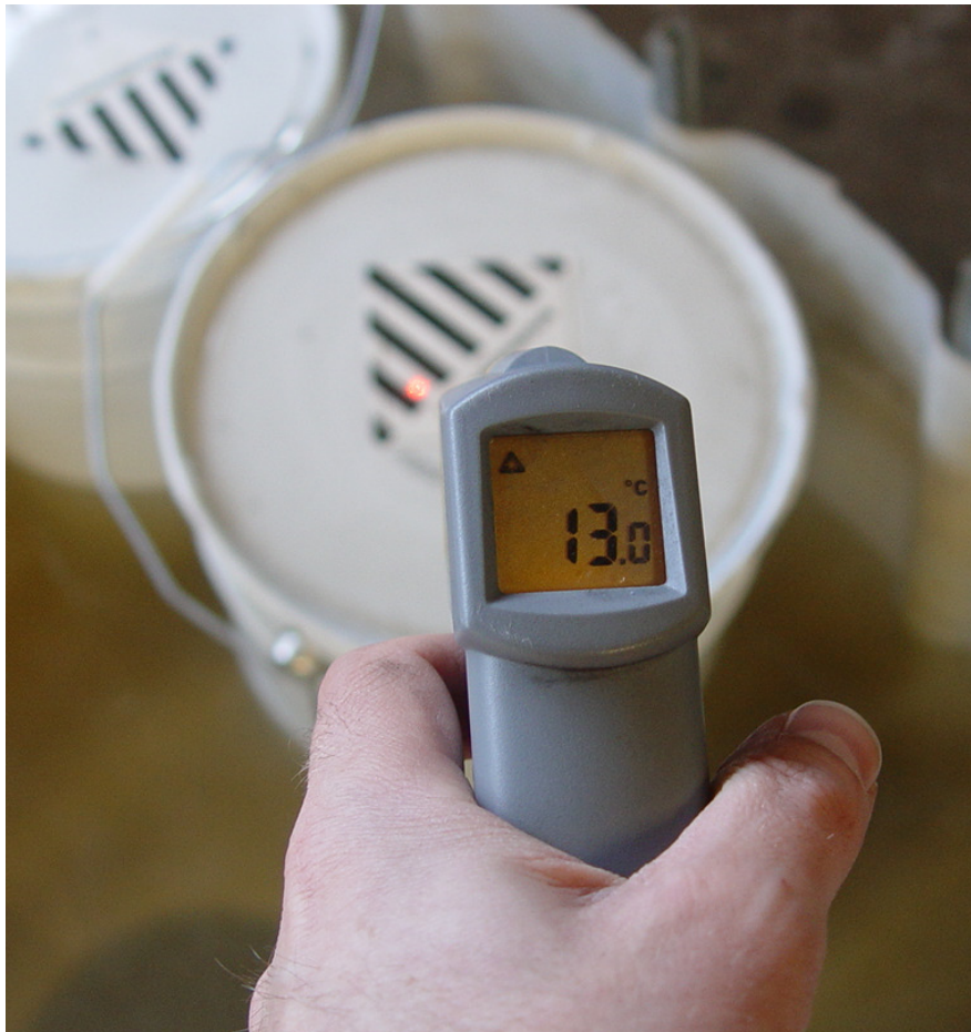
Abb. 33: Messung der Materialtemperatur mit dem IR-Thermometer
