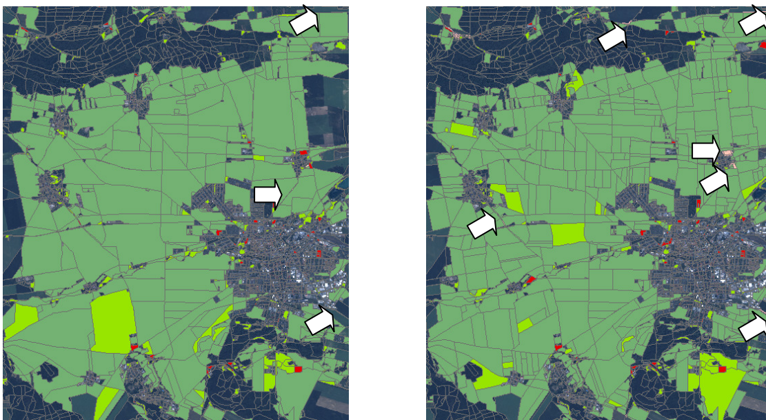
Abbildung 41: Graphische Darstellung der Konfusionsmatrix der Verifikationsergebnisse des ersten Analyseschrittes (pixelbasierte Klassifikation), links: Halberstadt, ATKIS, s_q = 30\% , rechts: Halberstadt, Schlagkataster, s_q = 40\% (TP: dunkelgrün, FN: hellgrün, FP: hellrot (durch Pfeile gekennzeichnet), TN: dunkelrot).
