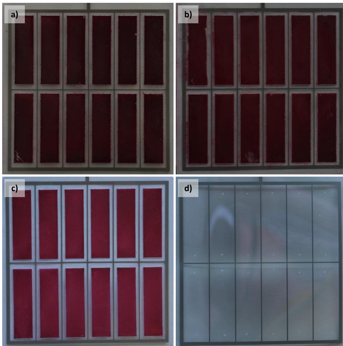
Abbildung 4-63: Fotografien der Zellkomponenten: Farbstoffsensibilisierte Photoanoden der Module a) DSC15, b) DSC16, c) DSC19; d) Exemplarische Gegenelektrode
