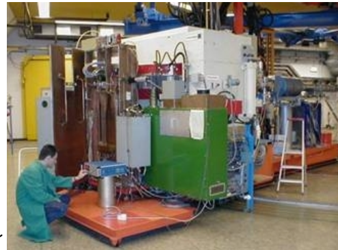
Abbildung 3.3: Energievariables Zyklotron, das um 158^\circ schwenkbar ist [PTB Fotografie].
