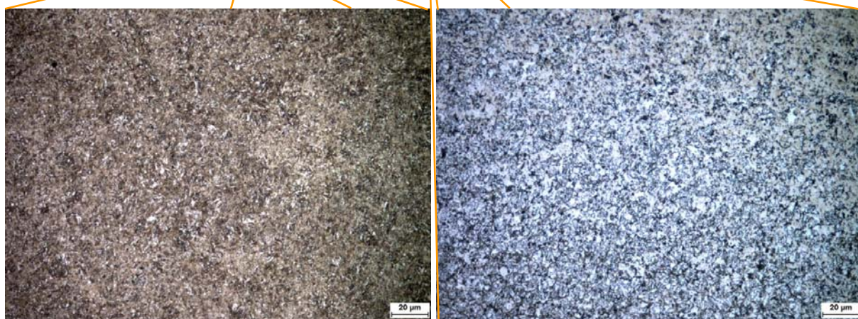
Bild 8-29: diodenlasergelötete Probe (200 W, 2 s): Übersicht (Mitte); Gefügebilder WEZ (oben), GW (links unten), Übergang WEZ / GW (rechts unten)
