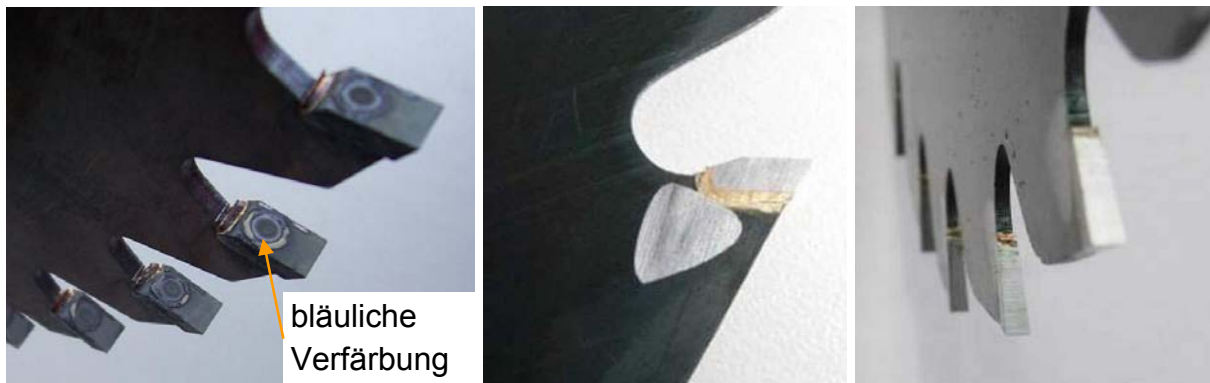
Bild 8-20: Sägeblatt nach dem Lötprozess (links) und in der Produktion geschliffenes Sägeblatt (Mitte und rechts)
