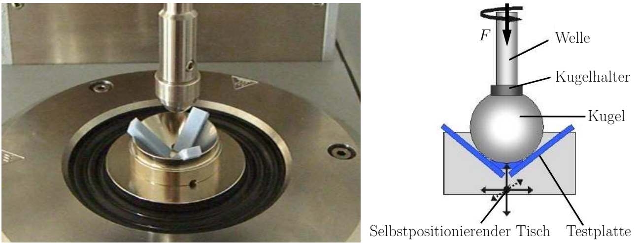
Abbildung 6.7: Messsystem des Tribometers
