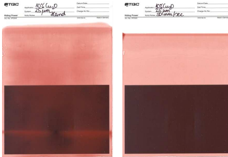
Abb. 5-27: Manuell (links) und mit dem automatischen Filmaufziehgerät (rechts) gerakelte Lackschichten mit Cu 2 O als Füllstoff
