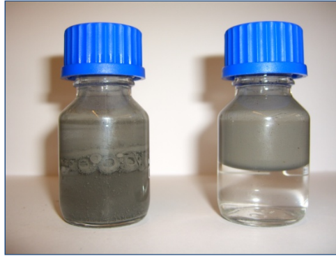
Abb. 6.1: Unterschiedliches Dispersionsverhalten von unmodifiziertem (links) und modifiziertem (rechts) Carbonyleisenpulver
