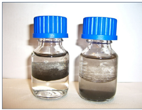
Abb. 3.6: Unterschiedliches Dispersionsverhalten von modifiziertem (links) und unmodifiziertem Magnetit-Pulver (rechts)
