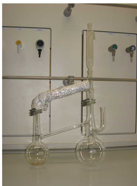
Abb. 28: Syntheseapparatur zur Darstellung der monobromierten Alkohole
