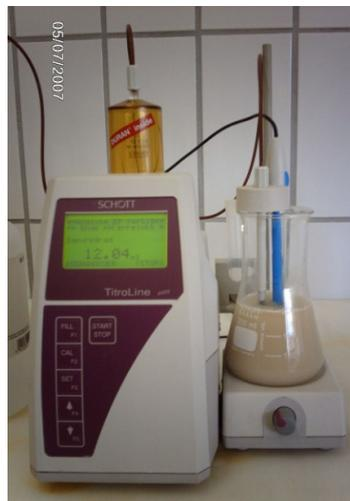
**Abbildung 16: Analyse von pH-Wert und Säuregrad mit dem Titrationsautomat**
