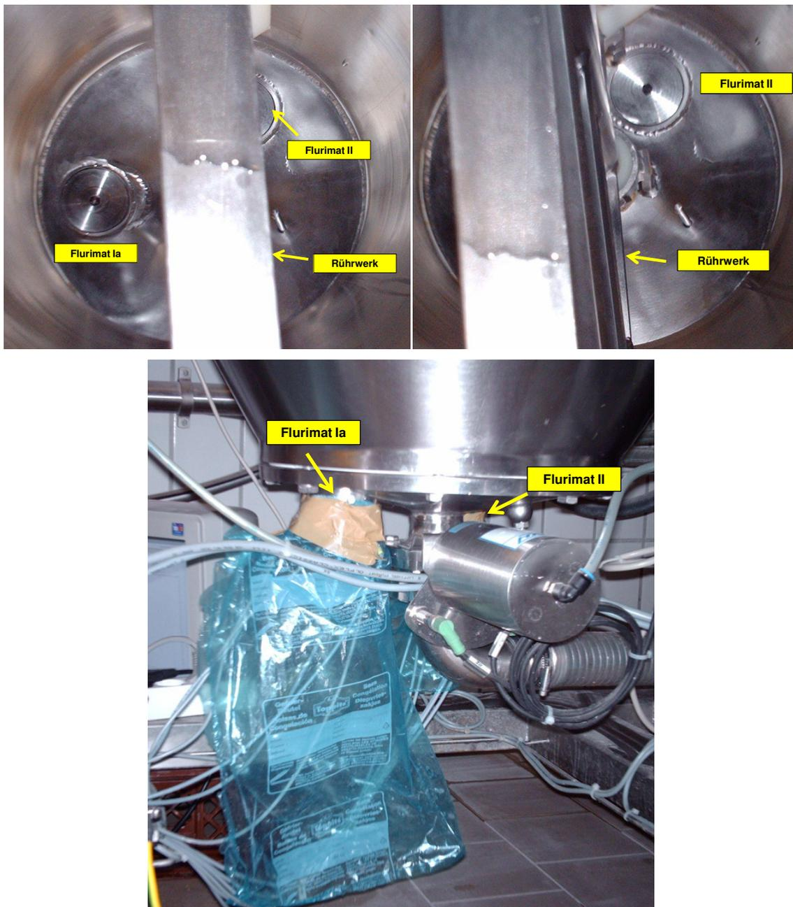
**Abbildung 14: Blick von oben in den Multifermenter aus zwei unterschiedlichen Perspektiven (oben) und von außen (unten). Beide Flurimaten sind am Boden angeschlossen.**
