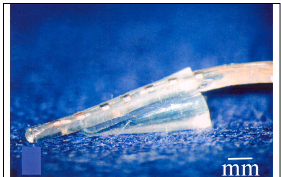
Abb. 2.11: Composite-Elektroden-System mit Positioner-Schiene aus Silikon in Keilform [Les-00]
