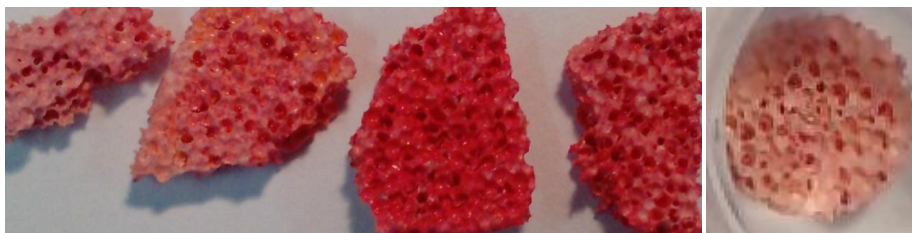
Abbildung 4-32: Alizarinrot Färbung der Zell-Keramik Konstrukte nach 28 Tagen dynamischer Kultivierung im Bioreaktor. Abgebildet sind Proben aus den Reaktoren 1,2 ,3 und4 und der Blindwert (von links nach rechts).
