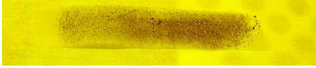
Abbildung 3.2: Fotografie eines Streifens Scotch-Klebeband mit darauf verteilten Graphit bzw. Graphen-Flocken, nachdem das Klebeband mehrfach gefaltet und abgezogen worden ist.
