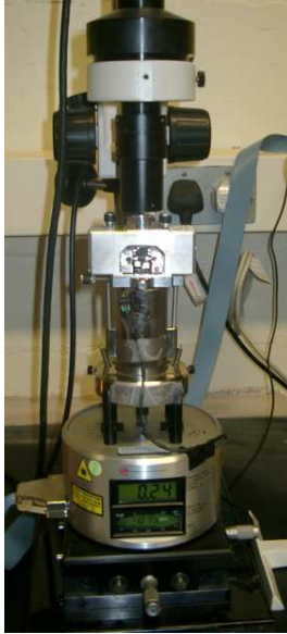
Abbildung 3.14: Foto des an der Lancaster University benutzten Rasterkraftmikroskops. Die Probe ist hier auf einem Piezo-Kristall wie in Abbildung 3.16 positioniert, um so Schwingungen im Ultraschall-Bereich übertragen zu können. Bei diesem Gerät handelt es sich um ein baugleiches Modell wie das in Hannover benutzte AFM.
