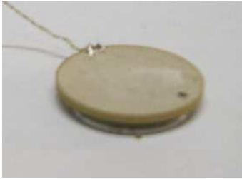
Abbildung 3.16: Foto eines Piezo-Kristalls, der für die UFM-Messungen benutzt worden ist. Seine Eigenfrequenz beträgt 2 MHz.
