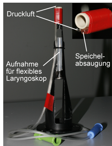
ABBILDUNG 6.19.: Abstandshalter zur Befestigung an der Laserscannereinheit mit Aufnahmehalterung für ein flexibles Laryngoskop, Düse für Druckluftzufuhr und Einrichtung zur Speichelabsaugung.
