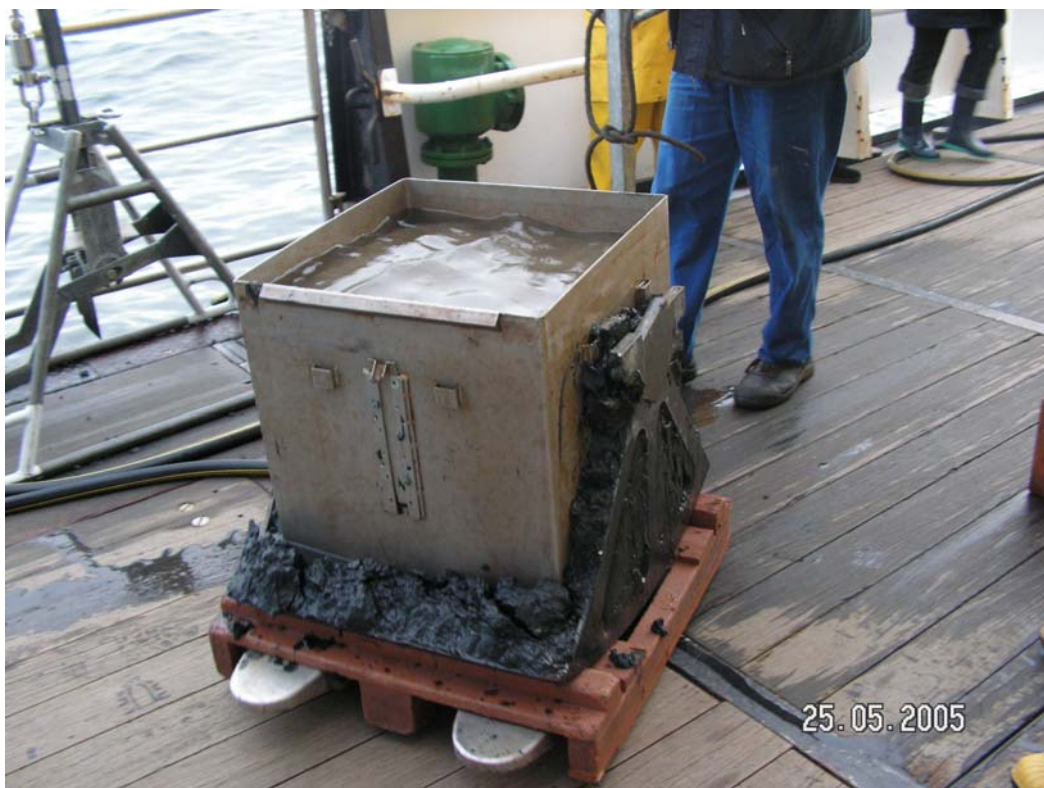
Abbildung 92: Sediment im Kastengreifer unmittelbar nach der Probennahme bei Station KS 11.
