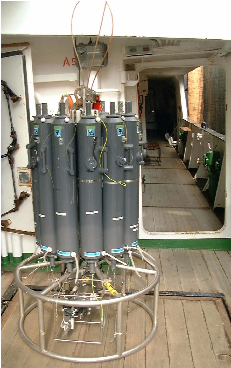
Abbildung 90: Zur Probennahme der Tiefenprofile verwendeter Kranzwasserschöpfer.
