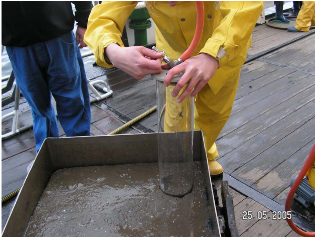
Abbildung 93: Entnahme des Probenmaterials mit Hilfe eines unter Unterdruck stehenden Kunststoffrohres. Das Sediment befindet sich noch im Kastengreifer.
