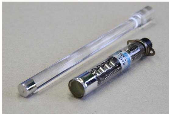
**Abbildung 2.7:** Szintillationskristall und Photomultiplier, wie sie im SEM verwendet werden
