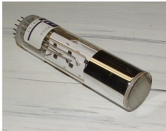
**Abbildung 2.3:** Ein Photomultiplier der Fa. Hamamatsu Photonics.
