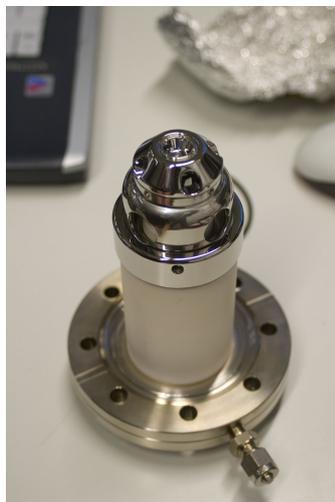
**Abbildung 2.5:** Bild eines Schottky-Emitters, der im JEOL JAMP-7830F verwendet wird.
