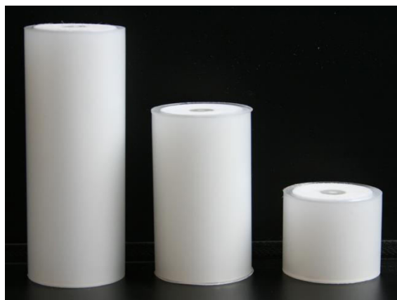
Abbildung 30: partikelgängige Membranadsorber-Wickel unterschiedlicher Länge: 120 mm, 80 mm, 40 mm; Wickeldurchmesser, 40 mm.
