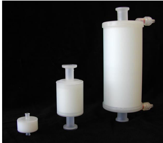
Abbildung 51: Maßstabsübertragung. Untersuchte Formate des partikelgängigen Membranadsorber-Moduls (von links nach rechts: Baugröße I, Baugröße II und Baugröße III).
