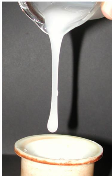
Abb. 4.2: Einfüllen eines zähflüssigen Synthesegels in einen Autoklaveneinsatz.
