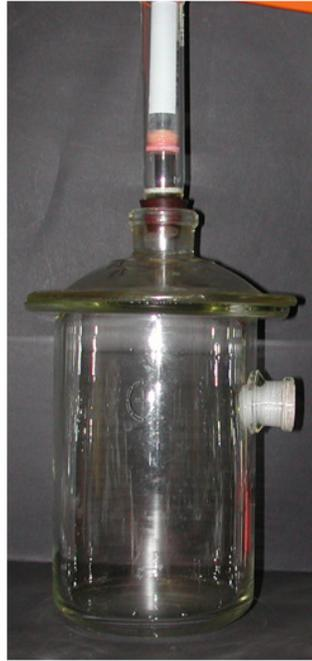
Abb. 4.3: Apparatur zum Herstellen von HAP-Komposittabletten.
