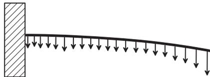
Abbildung 2.17: EFM als Balkenmodell
