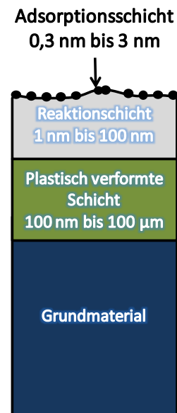
Abbildung 11: Schematische Zusammensetzung einer Oberfläche
