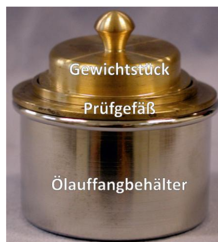
Abbildung 42: Prüfgerät nach DIN 51817 zur Bestimmung der statischen Ölabscheidung
