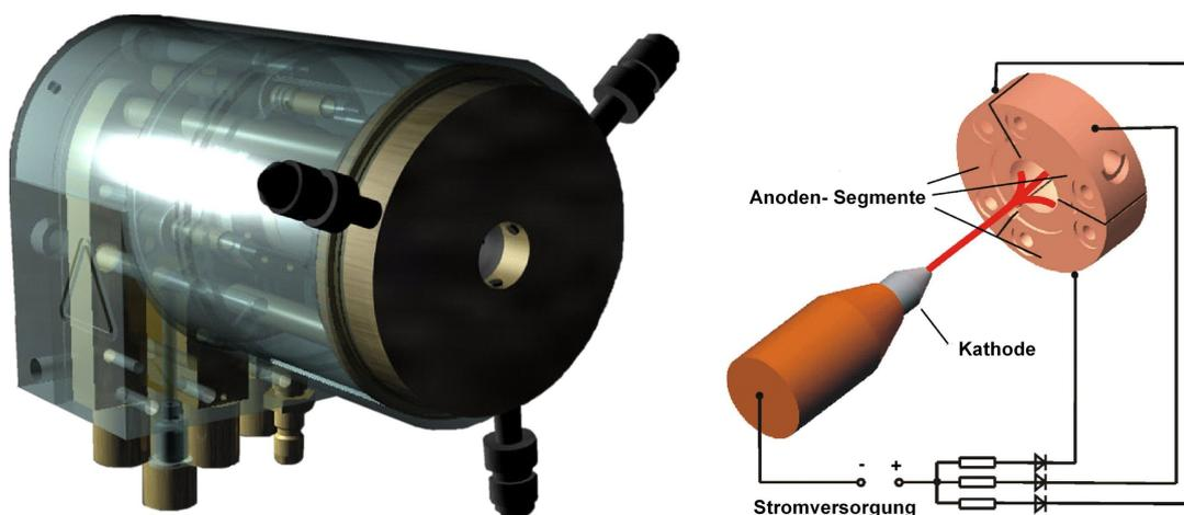
Abbildung 8: Aufbau eines Dreianodenbrenners des Typs Delta mit geteilter Anode
