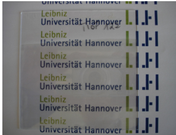
Abbildung 3-2: Hergestellt \text{TiO}_2 -Film aus \text{TiOSO}_4 / Pluronic F127/ \text{NH}_3
