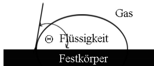
Abbildung 3-8: Dreiphasenpunkt des Kontaktwinkels
