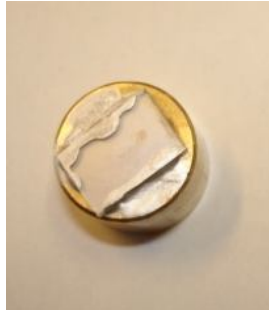
Abbildung 3-9: REM-Probenträger mit beschichtetem Glassubstrat, fixiert mit Silberleitlack
