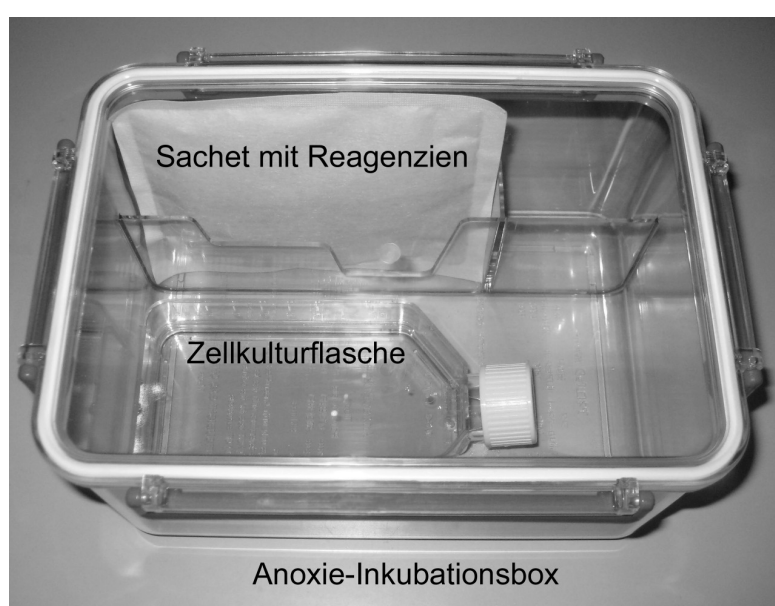
Abbildung 2-1: Sauerstoff-reduzierte Zellkultur durch Anoxie-Inkubationsbox, die in den normalen Zellkulturschrank gestellt wird.
