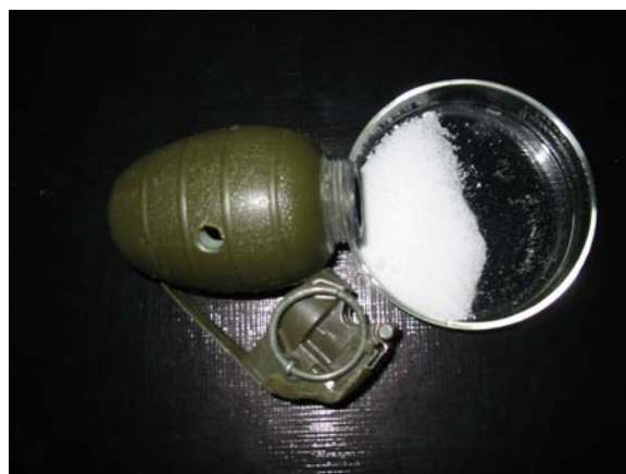
Abbildung 35. Granaten gefüllt mit weißem Pulver.- Der Sprengmechanismus wurde entfernt. Die Natur des weißen Pulvers soll mit dem MAE-Verfahren identifiziert werden.
