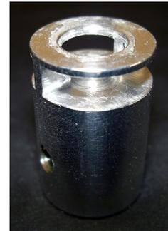
**ABBILDUNG 4.6:** Rotationsplattform für die Linsen.
