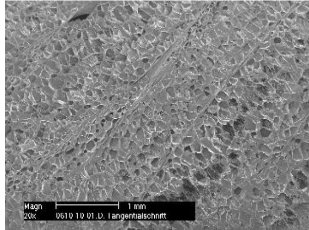
Abb. 4-10: REM-Aufnahme 50fache Vergrößerung, PP-Schaumtangentialschnitt mit wenigen Defekten, Drehzahl 7.5 1/min und Treibmittelanteil 3.4% CO 2
