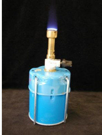
Abb. 4-79: Oxidierend eingestellte Flamme des Propangas Laborbrenners
