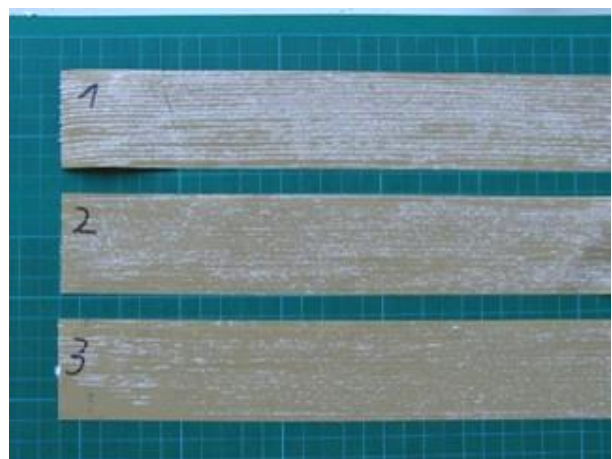
Abb. 4-81: Klebebandstreifen nach dem ersten (1), zweiten (2) und dritten (3) Abziehvorgang
