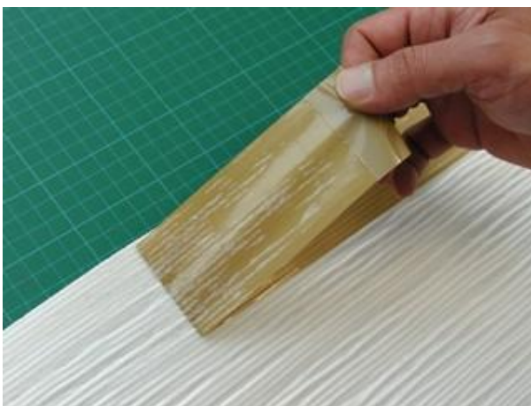
Abb. 4-80: Abziehen der Schaumoberfläche mit einem Klebeband
