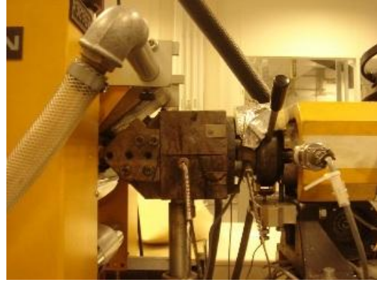
Abb. 3-10: Ausgang des Collin Laborextruders mit Breitschlitzdüse, (Mit freundlicher Genehmigung der Clariant Masterbatches GmbH Ahrensburg)
