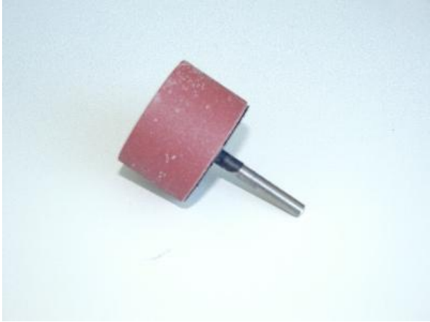
Abb. 4-75: Schleifhülse, die zum Abschleifen der Folien verwendet wurde
