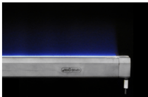
Abb. 4-103: Oxidierend eingestellte Flamme einer Beflammungsdüse, mit freundlicher Genehmigung der Arcotec GmbH Mönshheim
