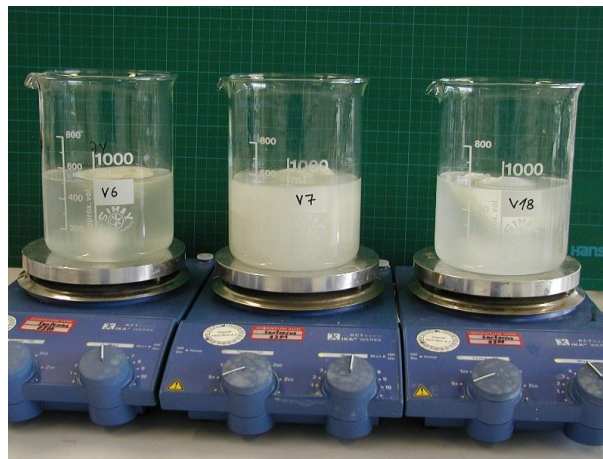
Abb. 4-194: Versuchsaufbau Löslichkeit, Bechergläser mit Schaumfolien in Wasser, Magnetrührer
