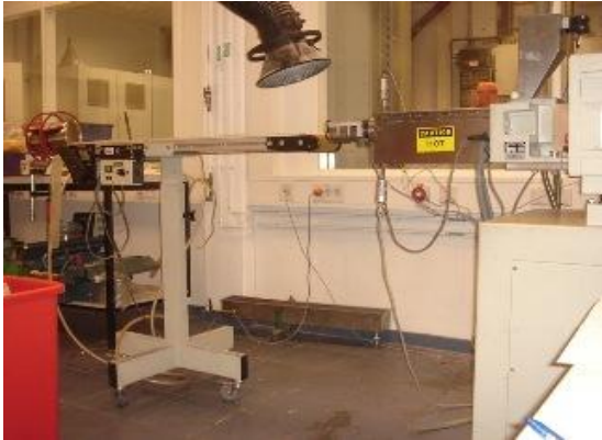
Abb. 3-7 Brabender Laborextrusionsanlage (Mit freundlicher Genehmigung der Clariant Masterbatches GmbH Ahrensburg)
