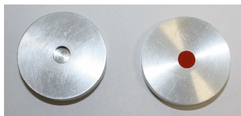
Abb. 12-1: Probenbehälter für die Farbmessung, links ohne Probe, rechts mit Probe
