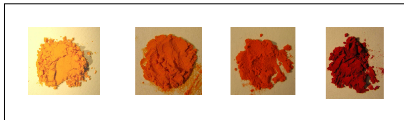
Abb. 5-2: Pulverförmige Mischphasen Zn_{1-x}Mn_xO mit x = 0.01 ; 0.05 ; 0.10 und 0.15 von links nach rechts
