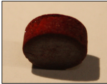
Abb. 7-2: Pulverpressling \text{Zn}_{0,88}\text{Mn}_{0,12}\text{O} nach dem Tempern
