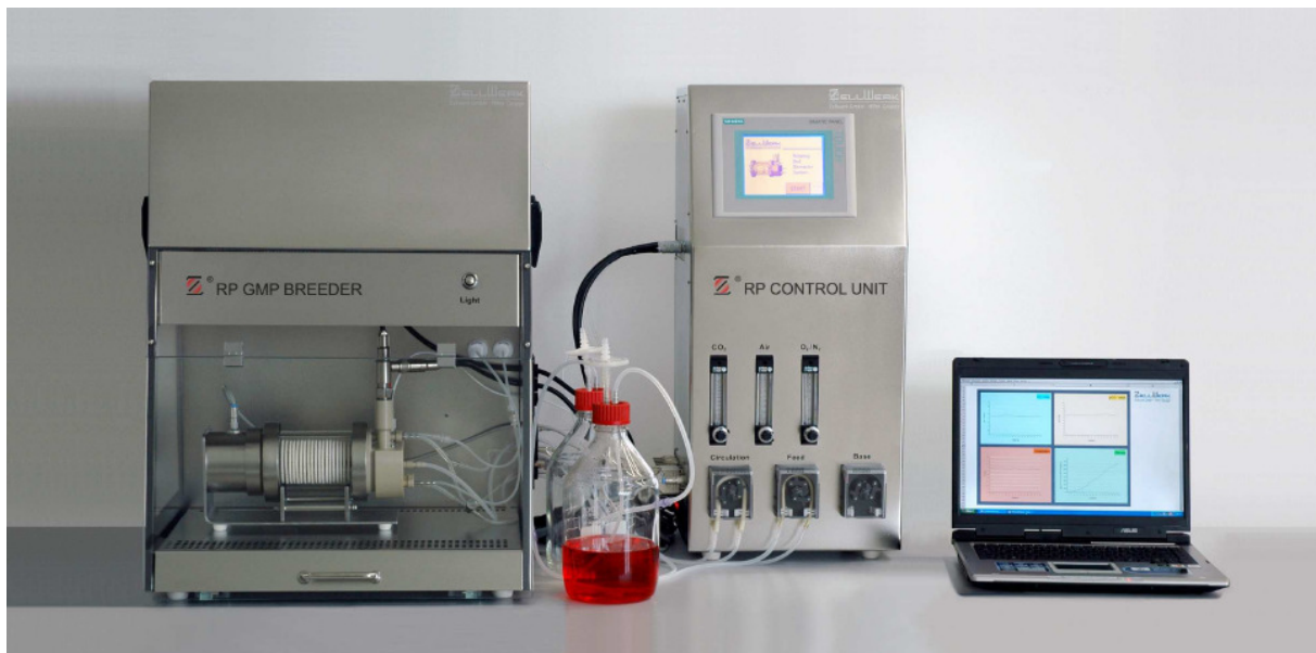
Abbildung 4-21: Das Z ® RP Reaktorsystem besteht aus einem Drehbett-Bioreaktor, der sich in einer GMP-konformen, beheizbaren Sterilwerkbank (Breeder) befindet. (entnommen aus: Betriebsanweisung Z ® RP Technologie) 129
