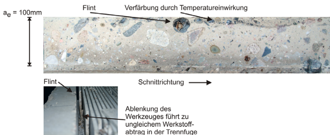
Abbildung 33: Trennfugenoberfläche eines Schnittversuches mit Beton E55 ( a_e = 100 \text{ mm} , v_{ft} = 1,5 \text{ m/min} ). Die Trennscheibe wurde in diesem Versuch zerstört. Der Flint (mitte ganz oben) führte zur Ablenkung des Werkzeuges und so zu Kontakt zwischen Werkzeug und Werkstoff. Die dunkle Verfärbung rechts vom Flint entstand durch diesen Kontakt.
