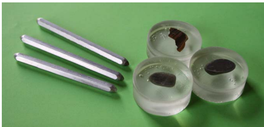
Abbildung 11: Prüfstifte zur Ermittlung der Mohsschen Härte (links) und in Kunstharz eingebettete Proben der Gesteinskörnungen (Beispiel)
