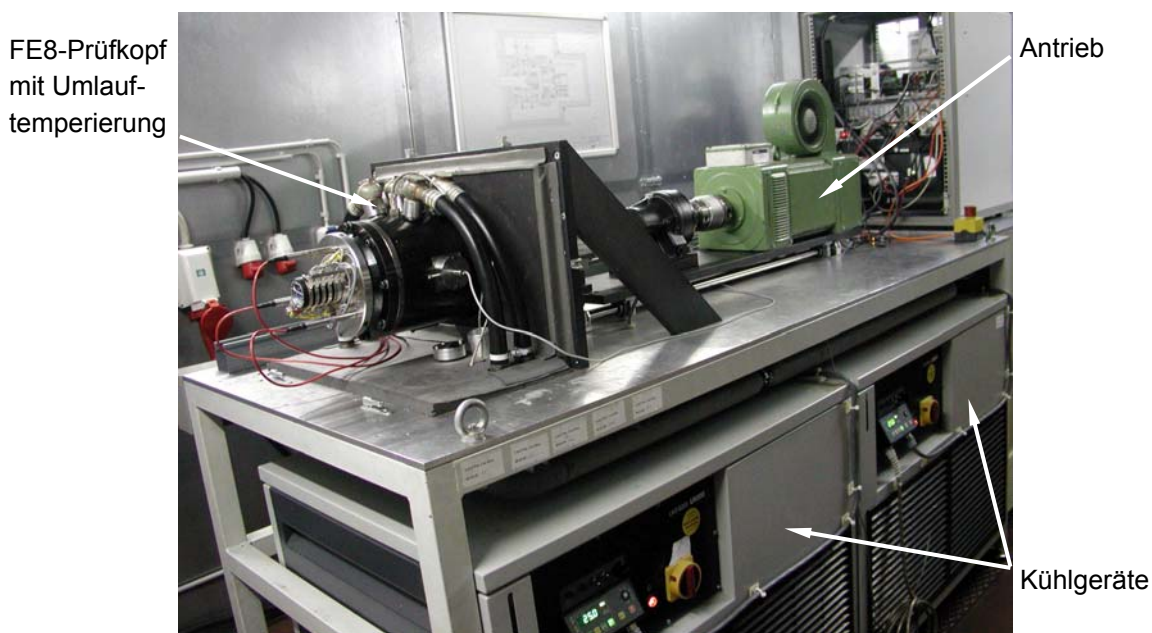
Abb. 2-3: Gesamtansicht des modifizierten FE8-Prüfstandes [48]
