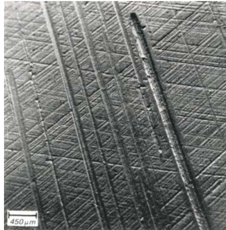
Abb. 3-11: Riefen durch Abrasion bei Gleitverschleiß [17]
