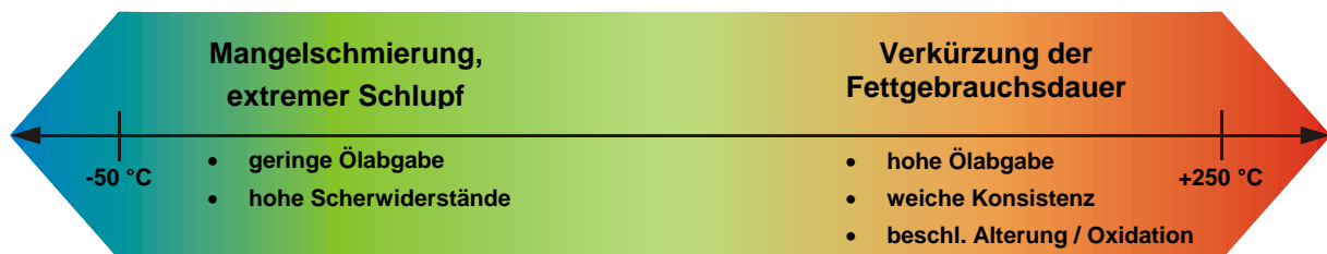
Abb. 1-3: Temperatureinfluss auf die Schmierwirkung von Fetten
