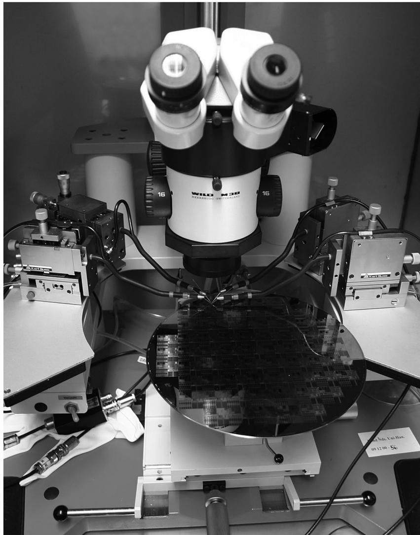
Abbildung 4.1: Verwendeter Waferprober der Firma Süss, bestehend aus einem heizbaren Messing-Chuck, der über Stellschrauben verfahrbar ist (Mitte, hier mit Wafer belegt), vier Messnadeln (jeweils zwei links und rechts) und einem Lichtmikroskop.
